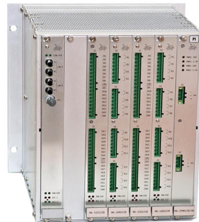
Рис. 3. Выносное устройство NPT microRTU
