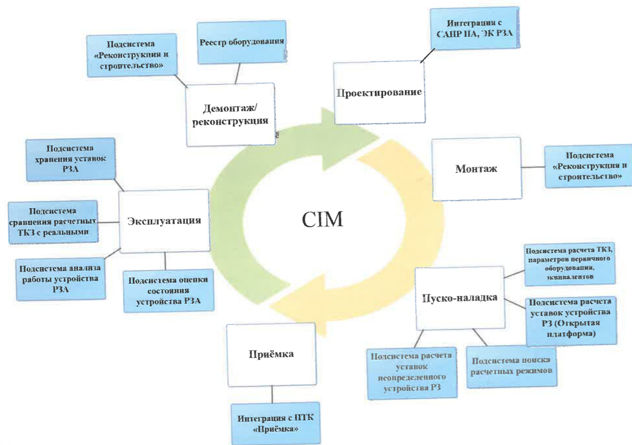
Рисунок 1. Структурная схема жизненного цикла устройств РЗА с привязкой каждого этапа к подсистемам ПТК «Эксплуатация»
